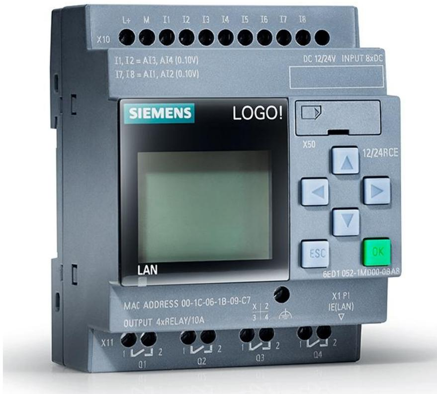
Le **Logo 8** remplace les deux modèles d'automate précédent 6 et 7 et est caractérisé par une manipulation simplifiée, un encombrement réduit avec plusieurs sorties numériques et analogiques, ainsi qu'une amélioration du ratio prix-performance. Le nouvel automate Logo 8 de Siemens dispose de la communication Ethernet, de fonctions supplémentaires pour le fonctionnement à distance et l'accès à distance, ainsi que la configuration simple des fonctions de communication.
